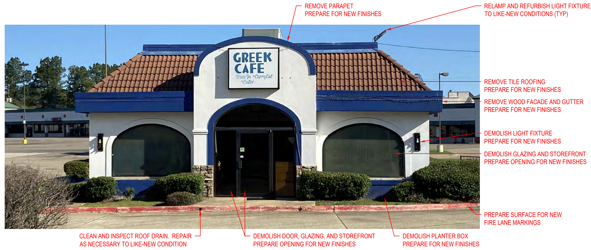
D1 DEMOLITION ELEVATION
