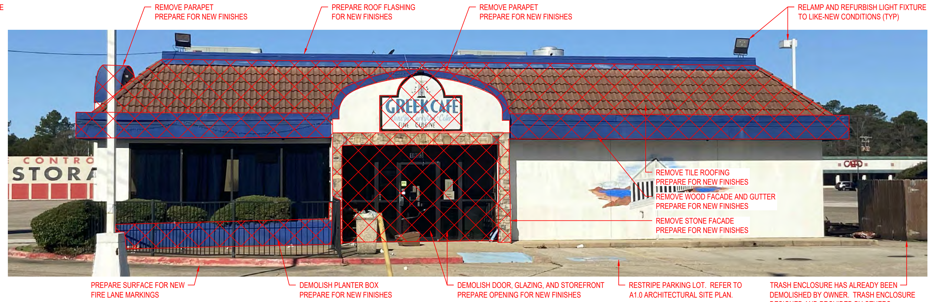
D2 DEMOLITION ELEVATION
